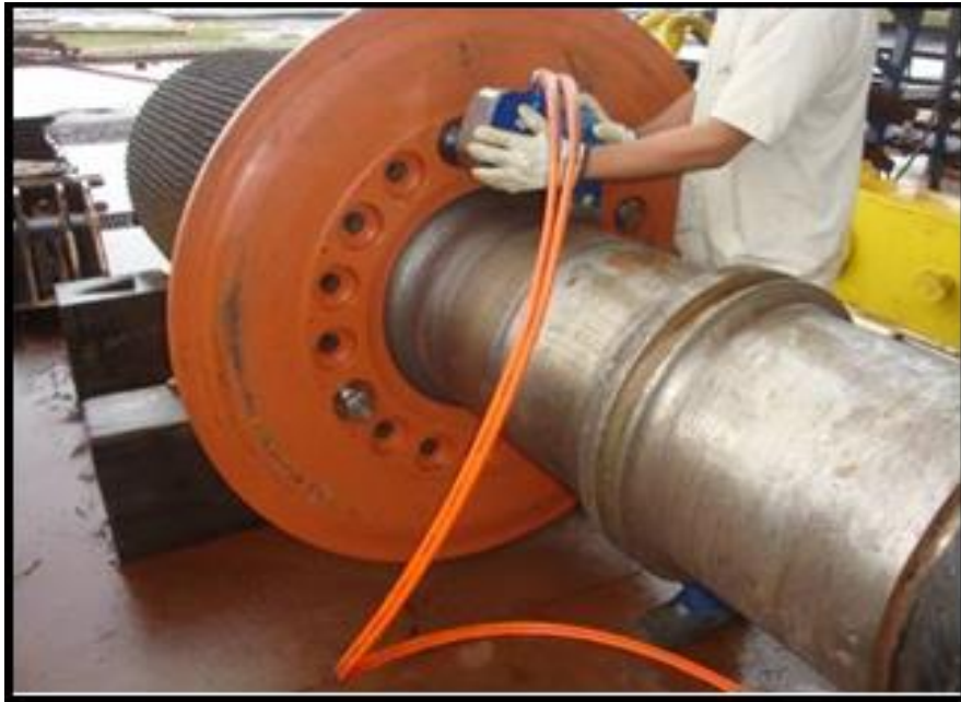
Figura 6 - Montagem dos parafusos no flange
