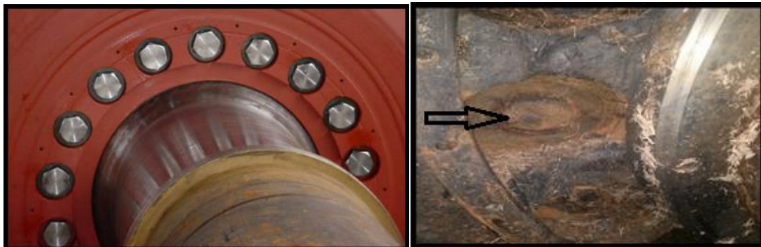
Figura 7 – (a) Flange montado com os parafusos. (b) Flange com parafusos quebrados
